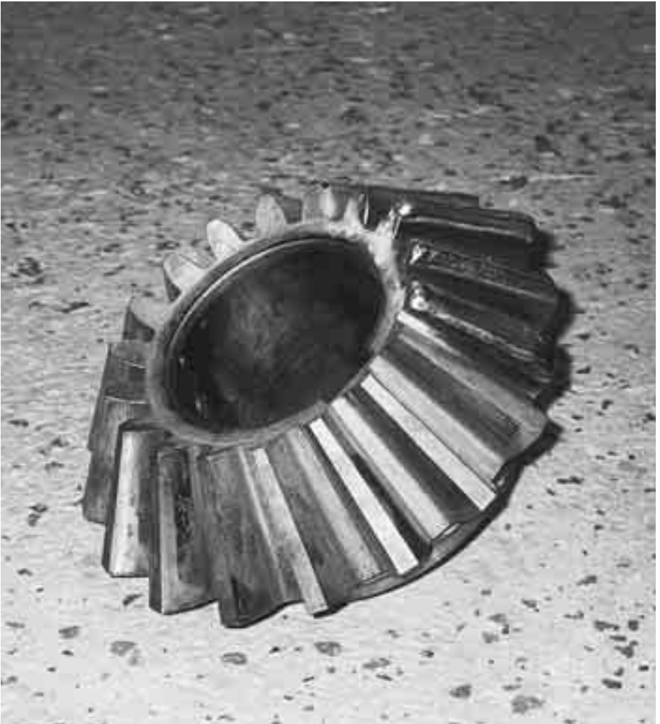
Getriebezahnrad, repariert mit OK 68.82.
