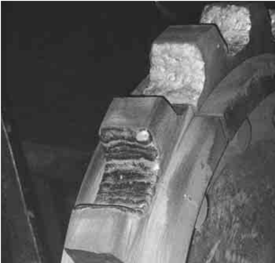
Kettenrad: Vorbeugende Instandhaltung mit OK 83.28.
