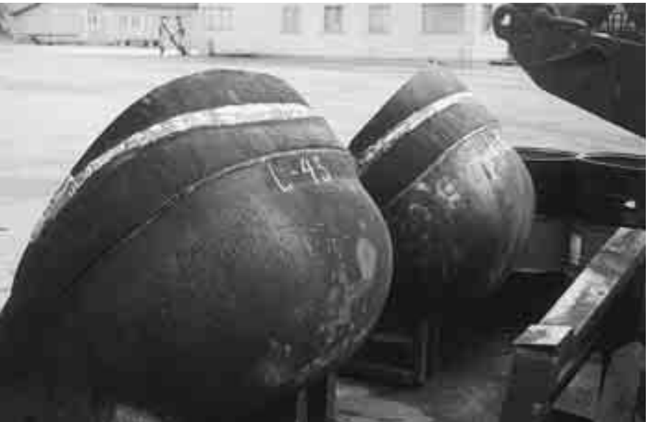
Baggerlöffel, Anschweißen neuer Lippen mit OK 68.82
