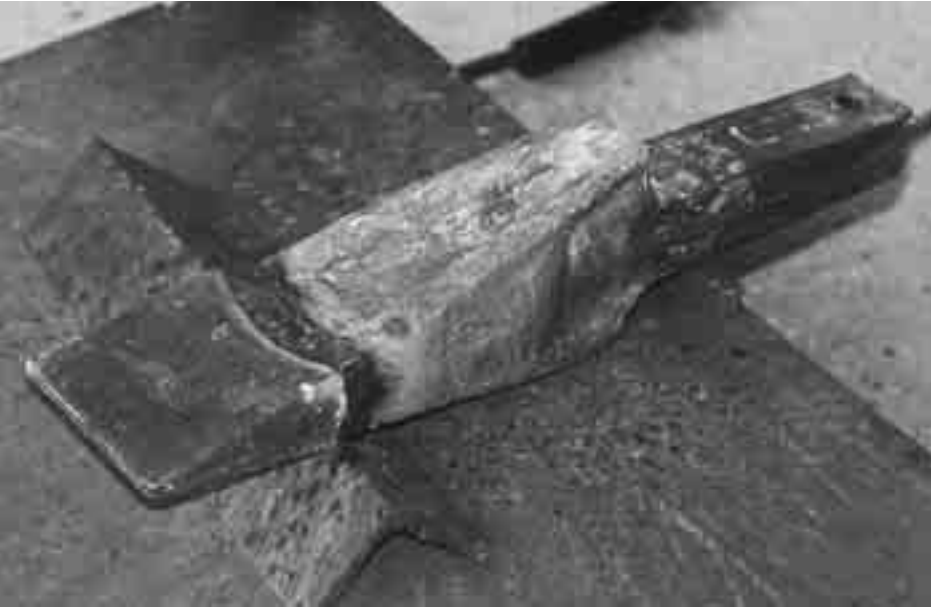
Anschweißen eines neuen Baggerzahnspitze mit OK 67.43 oder OK Tubrodur 14.71.
