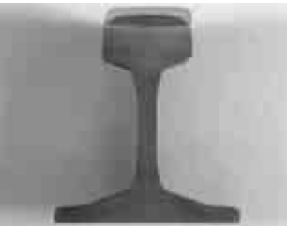
Kohlenstoff-Manganschiene: OK Tubrodur 15.43
