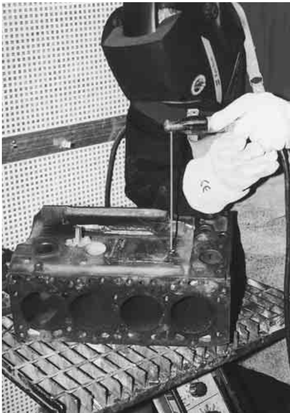
Motorblock. Gußeisenreparatur mit OK 92.18 und OK 92.60.
