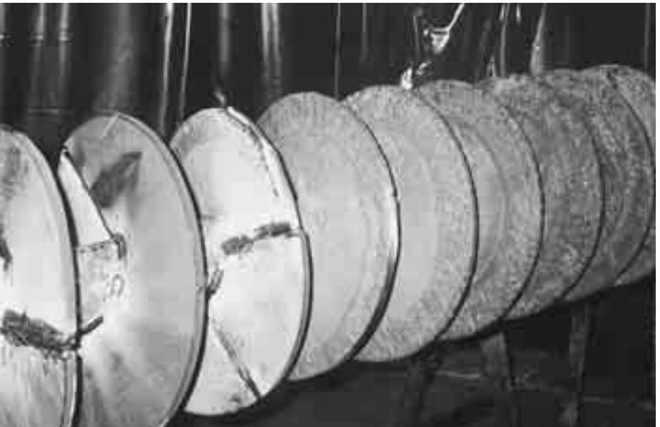
Förderschnecke: OK Tubrodrur 14.70 zum Hartbeschichten
