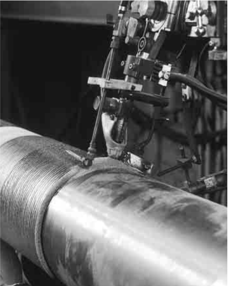
Instandsetzung von Stranggußrollen Schweißzusatz: OK Tubrodur 15.73 / OK Flux 10.37 Anlage: ESAB A6 HD SAW
