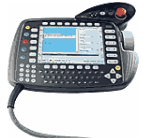
Programmierung mit dem KUKA-Control-Panel (KCP mit Windows Bedienoberfläche) an einem 2'000 kg schweren Werkstück.
