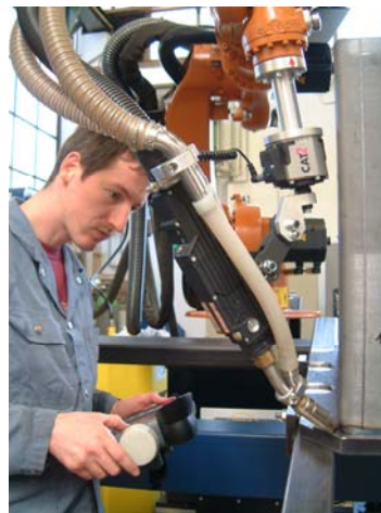
Programmierung mit dem KUKA-Control-Panel (KCP mit Windows Bedienoberfläche) an einem 2'000 kg schweren Werkstück.
